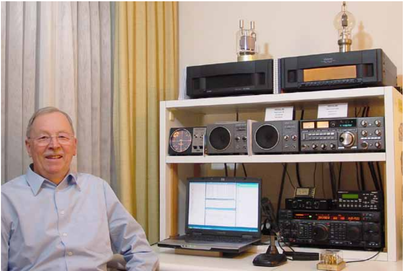
Photo 9: HB9AJW's heutige Homestation bestehende aus TRX FT-1000 und Leistungsverstärker VL-1000 mit 500 Watt (solid state)
