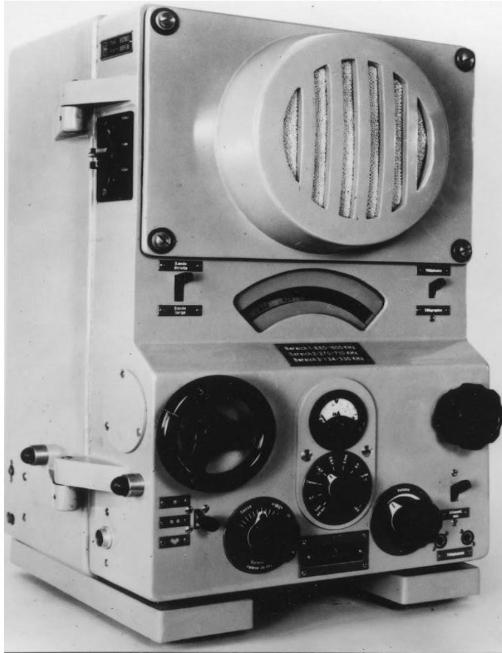
Peilempfänger Typ H-53, 35 kHz - 1520 kHz von Hasler AG Bern
