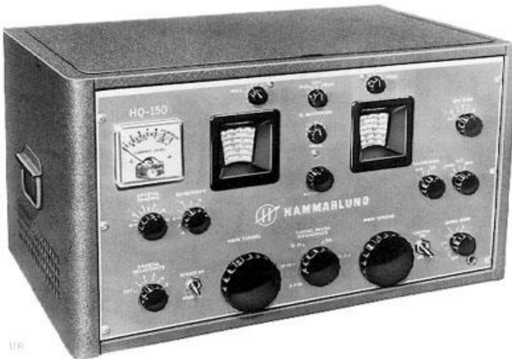
1960er-Jahre - im Orange-Netz verwendete man u.a. auch diesen Kurzwellenempfänger, Hammarlund HQ-150 , 540 kHz-31 MHz in 6 Bereichen mit Bandspreizung. Hergestellt: 1956-1958
