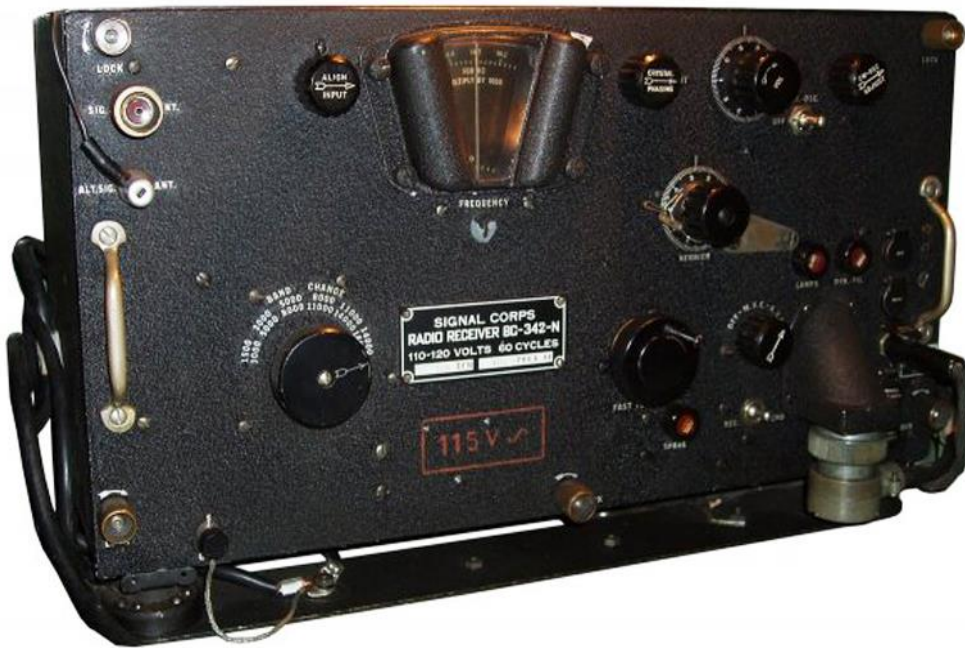
1950er-Jahre - im AND-Armeenachrichtendienst gab es diesen Kurzwellenempfänger von der US Army Signal Corps, BC-342-N , in 6 Bereichen von 1.5-18 MHz. Konstruktionsjahr: 1936 Beschaffung: 1948
